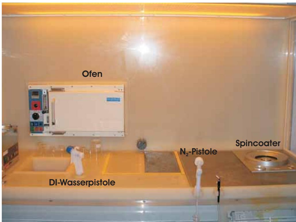
Abbildung 2.7: Nahaufnahme der rechten Werkbank mit dem Naßarbeitsplatz
