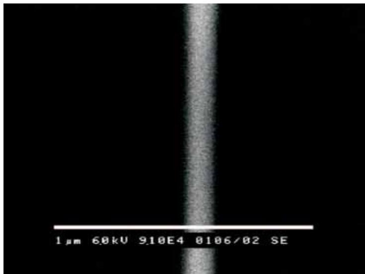
Abbildung 3.5: kleinste auf GaAs geschriebene Linienbreite von etwa 100nm bei einer Liniendosis von  $1,4nC/cm$
